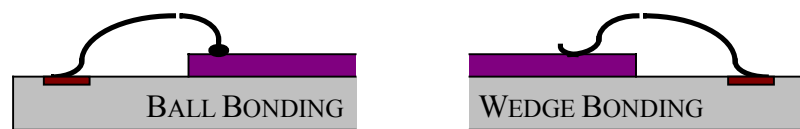
Figure III-2: Deux techniques de wire bonding .
